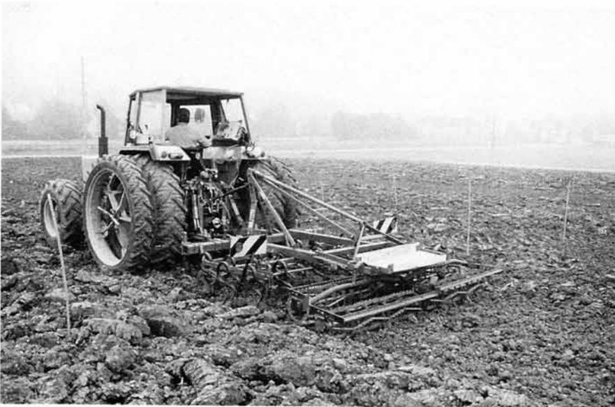
Fig. 4. Le vibroculteur nécessite une très faible puissance. C'est un outil très économique. Sur des sols moyens, il a permis de préparer des lits de semences motteux qui, avec le blé d'automne, ne se sont cependant jamais traduits par des baisses de rendement.
