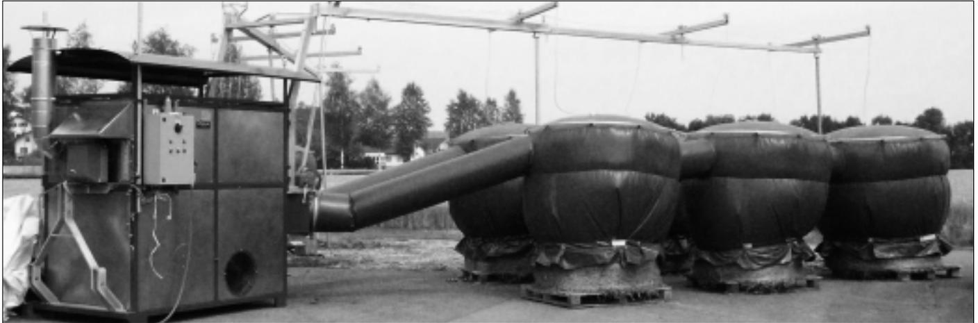
Abb. 6: Belüftungssystem Tecnomat: Obenbelüftung mit Hauben und Luftaustritt an unterer Stirnseite.
