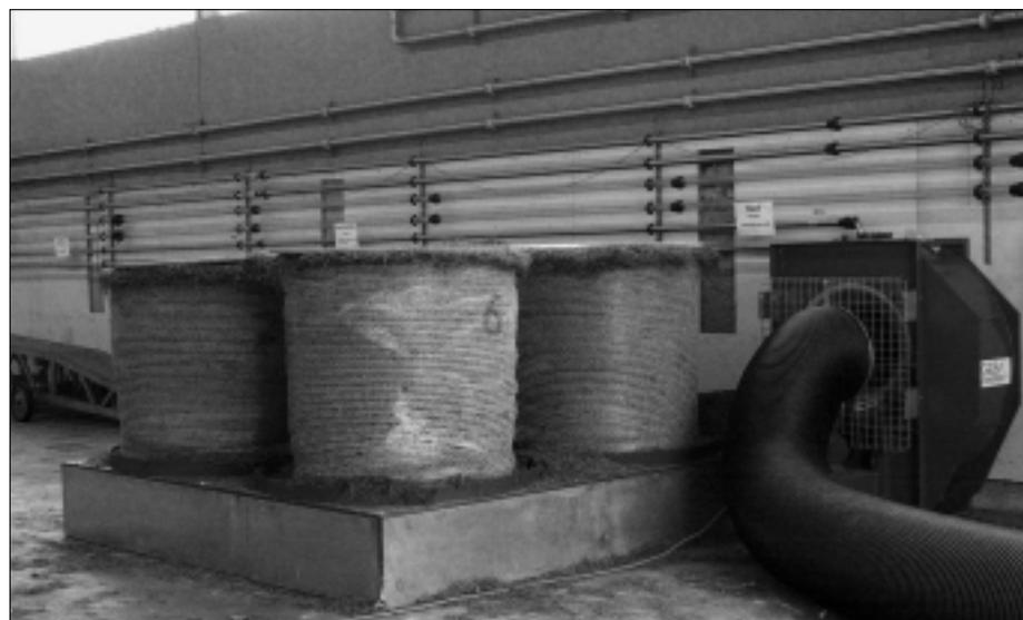
Abb. 4: Belüftungssystem Geba-Zumstein: Untenbelüftung mit Holzdeckel auf oberer Stirnseite und bauchseitigem Luftaustritt.
