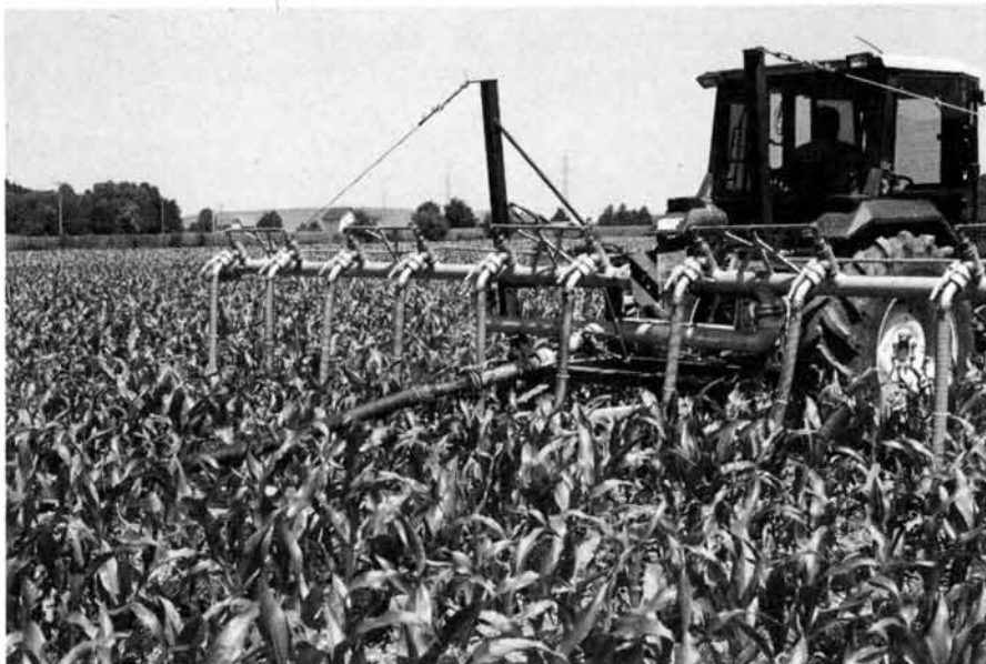
Abb.3: Beim Schleppschlauchverteiler fliesst die Gülle direkt zwischen den Maisreihen auf den Boden, ohne dass die Blätter verschmutzt werden.
