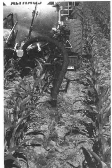
Abb. 9: Der Gülledrill erfordert eine exakte Maissaat und einen vollständig abgetrockneten Boden. Durch den Zinkennachlauf erhöht sich der Zugkraftbedarf um das 2- bis 4fache.
