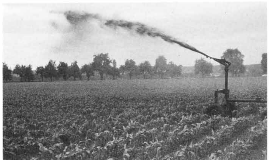
Abb.6: Der Regenautomat kommt dank der grossen Arbeitsbreite auf eine hohe Flächenleistung. Bei windigem Wetter und in der Nähe von Siedlungsgebieten ist sein Einsatz nicht zu empfehlen (Abdrift, Geruchsemissionen, schlechte Verteilung).
