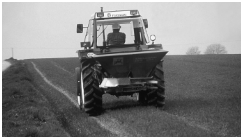
Fig. 2: Avec un distributeur centrifuge, seul un dispositif spécial permet d'épandre les engrais régulièrement en bordure de champ avec un minimum de pertes.
