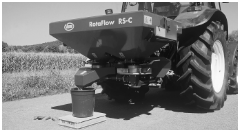
Fig. 9: Seul l'étalonnage du débit permet de contrôler de manière fiable la quantité d'engrais à épandre avant le début des travaux. Il est recommandé d'effectuer cet étalonnage au moins à chaque changement d'engrais et au moins une fois par an.
