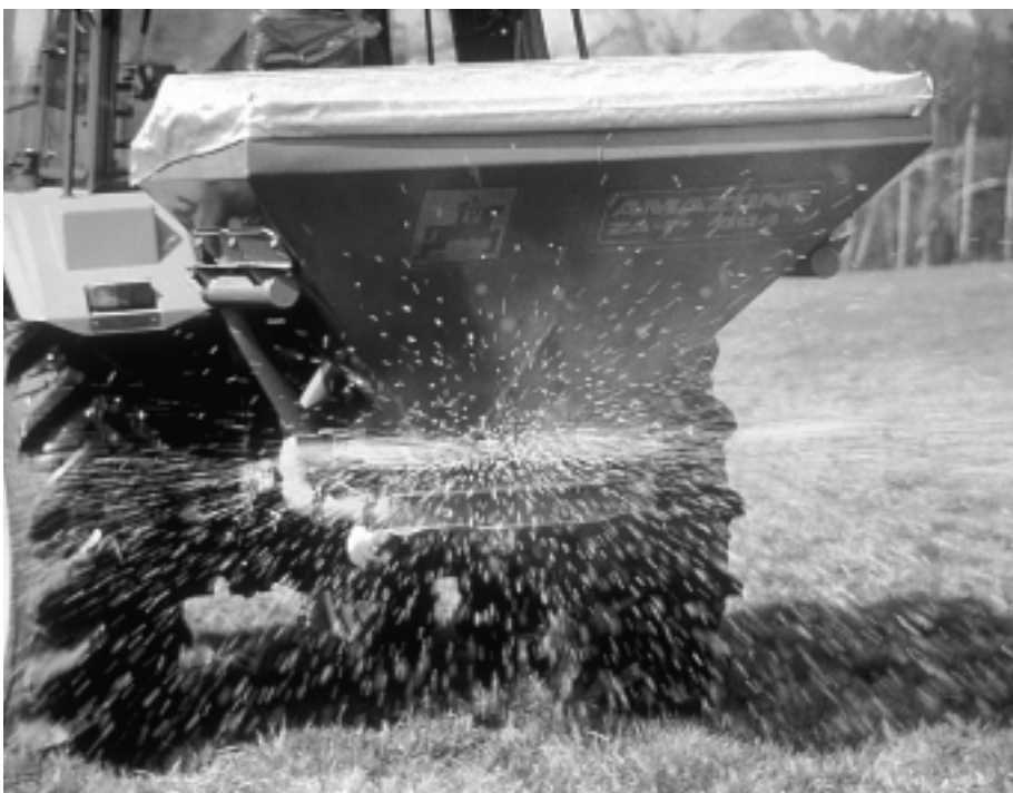
Fig. 1: Aujourd'hui, des distributeurs modernes à deux disques permettent l'épandage exact d'engrais minéraux dans la quantité voulue et avec une précision élevée.
