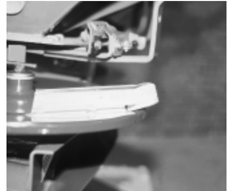
Fig. 4: Pour la fumure tardive lorsque les plantes sont à un stade de développement avancé, la plupart des fabricants travaillent avec des aubes d'éjection spéciales.
