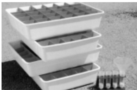
Fig. 7: Un tel set de test sert à contrôler la précision d'épandage sur la parcelle. Son utilisation est recommandée lorsque les engrais épandus sont d'origine inconnue.
