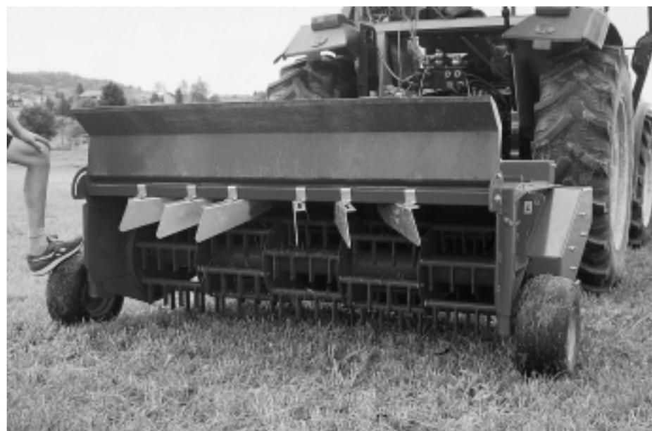
Fig. 3: Le Kurmann K 618 est équipé d'un rotor de ramassage à cinq éléments avec des fléaux battants en acier. L'étalement sur la surface du fourrage conditionné s'effectue à l'aide de tôles de guidage réglables en continu.
