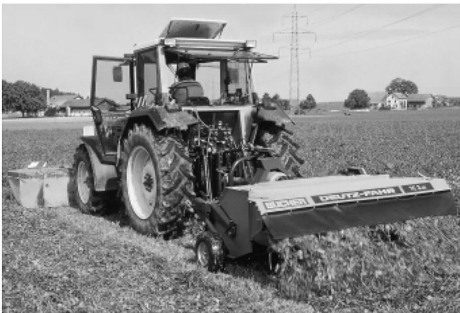
Fig. 1: Les conditionneurs traînés attelés à l'arrière du tracteur jouissent d'une popularité de plus en plus grande grâce à la grande diffusion des faucheuses frontales. Quatre outils ont été soumis à un test comparatif.
