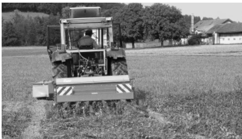
*Fig. 8: Le Kurmann K 618 Twin dépose le fourrage conditionné sur environ 80% de la largeur de fauche et remplit donc les exigences pour un étalement correct du fourrage sur la surface.*
