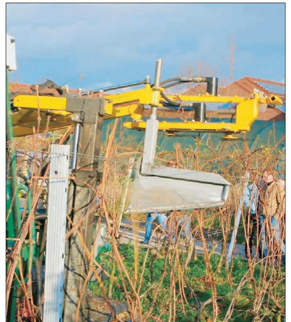
Abb. 6: Entranker und Vorschneider von Hundinger (Eigenkonstruktion).
