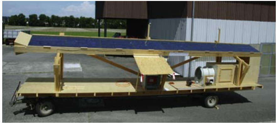
Fig. 3: L'installation d'essai (installation PV) d'ART se compose de huit modules photovoltaïques, intégrés à la toiture (20°). Un ventilateur (en bas à droite) avec débitmètre en amont permet de régler la vitesse de l'air en continu entre 1 et 7 m/s.
