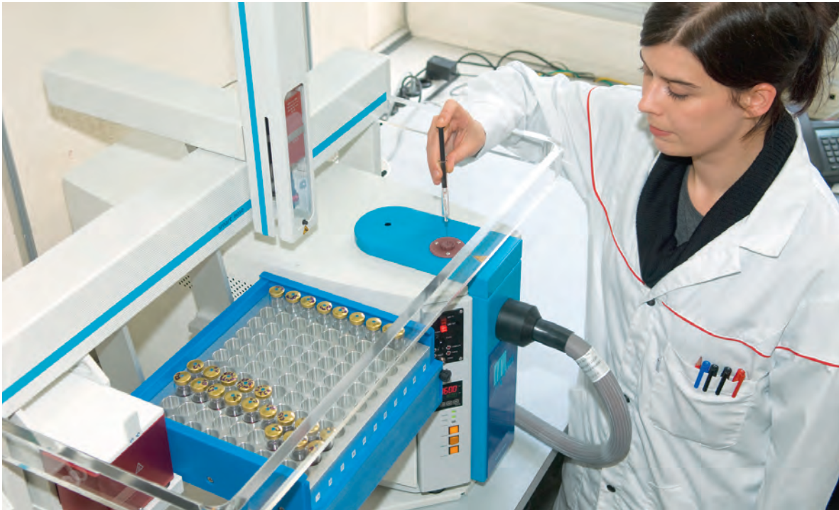
Analyse von Fruchtaromen mit der elektronischen Nase SMart Nose®.
