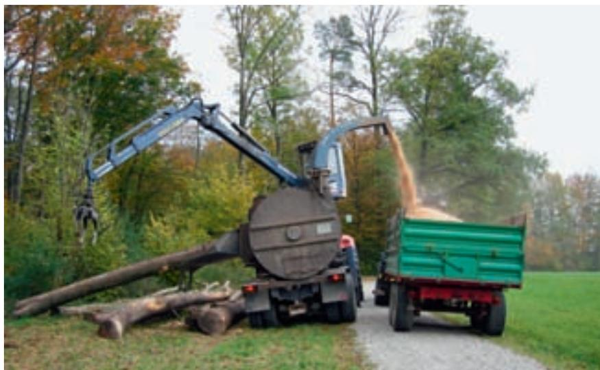
Fig. 6: Un broyeur automoteur et une grue facilitent non seulement le travail, mais, lorsqu'ils sont employés en commun par plusieurs exploitations, ils reviennent également moins cher que les hacheuses portées ou tractées entraînées à la prise de force.
