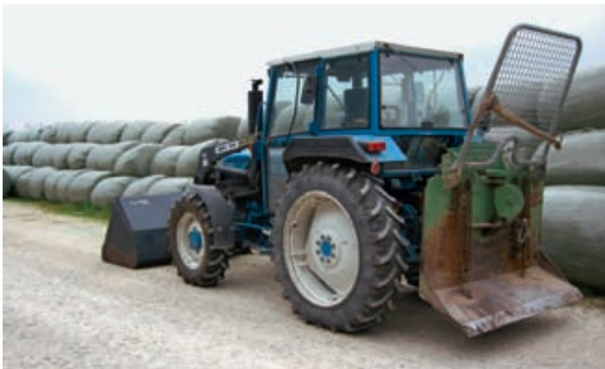
Fig. 4: L'emploi d'un chargeur frontal et d'un treuil permet de réduire considérablement la charge de travail. Les coûts de machines élevés font que ce procédé reste le plus onéreux.
