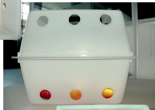
Abb. 4: Sensor-kammer: l. o.: Oberer Teil mit Sensor Mitte: geschlossene Sensorkammer u. r.: unterer Teil mit Äpfeln
