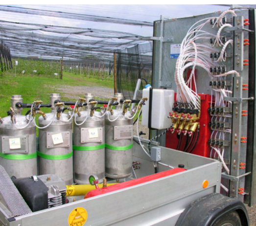
Sprühgerät, bei den Streptomycin-Exaktversuchen 2009 in Wädenswil eingesetzt. Atomiseur qui a fait l'objet d'essais de précision en 2009 à Wädenswil sur la dispersion de streptomycine.
