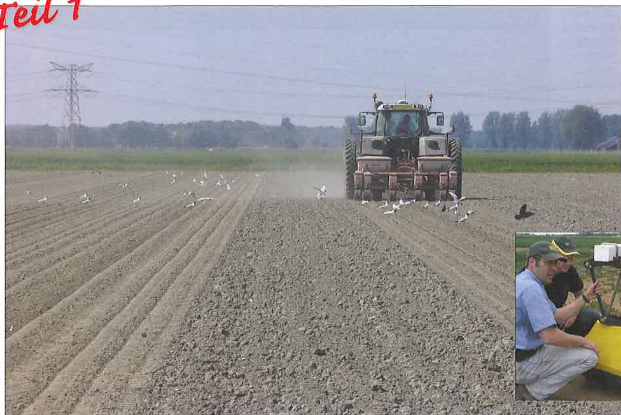
Abb. 1: GPS-gelenkte Anwendungen. Links Einzelkornsaat, rechts gezielte Zwischenreihenapplikation von Glyphosaten im Getreidebau.
