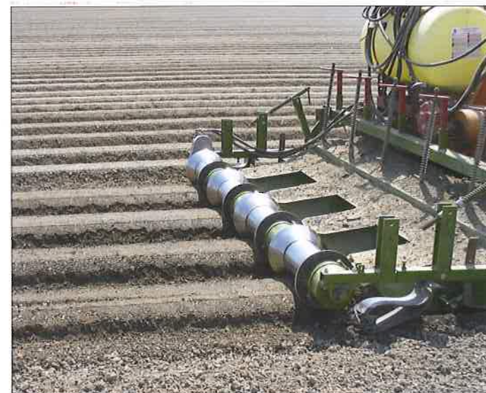
Abb. 4: Nachlaufsteuerungen. Oben Trimble TrueTracker, unten Dammformer mit GPS-gesteuerter Querpositionierung über hydraulischen Verstellrahmen im Dreipunkt.
