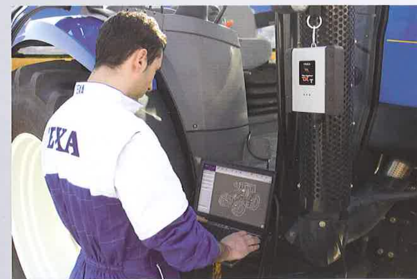
Die Diagnose erfolgt mit dem TEXA Navigator per Bluetooth oder USB am Laptop.
