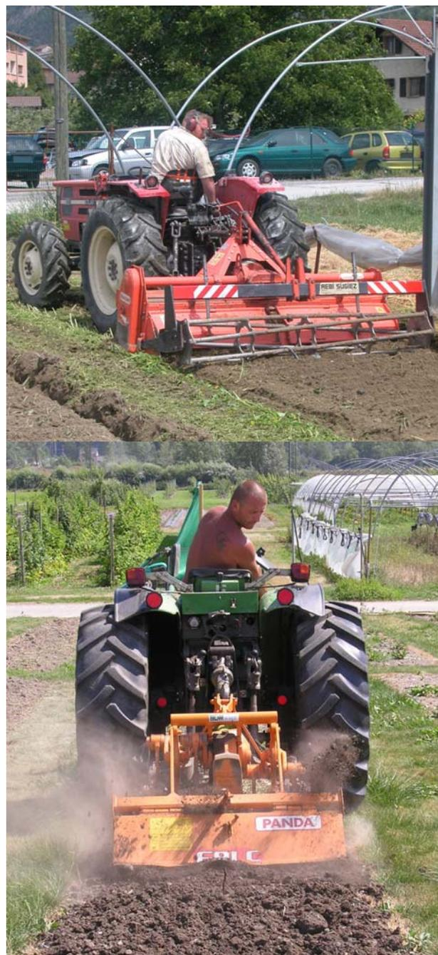
**Fig. 4:** Enfouissement immédiatement après le broyage soit avec une fraise (en haut) ou une bêcheuse (en bas)..
