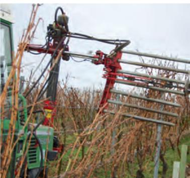
Abb. 7: Werden beim Ero Entranker mehrere Stäbe durch den Drahtrahmen gezogen, kommt es leicht zum Abreißen von Trieben und Verziehen von Stöcken.
