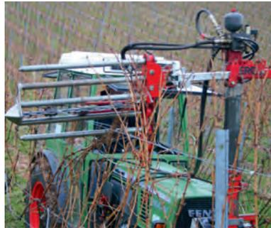
Abb. 8: Schonendes Entranken und Vorschneiden mit dem Ero Gerät. Das Messer läuft über dem Draht und ein Stab entranke den oberen Drahtbereich. Die Rutenlänge ist auch für Einbogenschnitt ausreichend.
