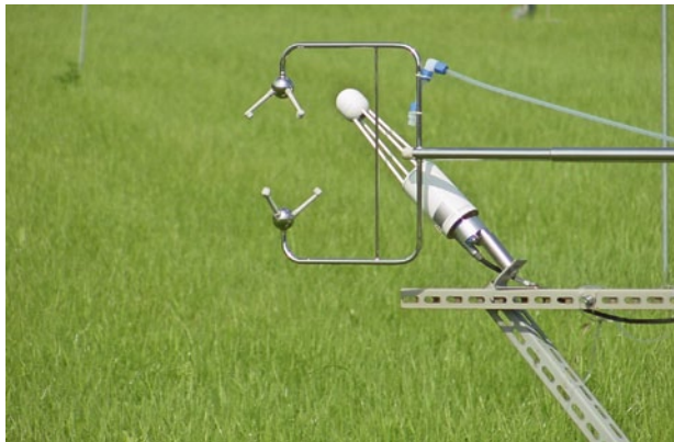
Figure 4 | Système dit d'Eddy-Covariance pour la mesure de l'évapotranspiration, constitué d'un anémomètre à ultrasons et d'un capteur à infrarouges. (Photo: ART)
