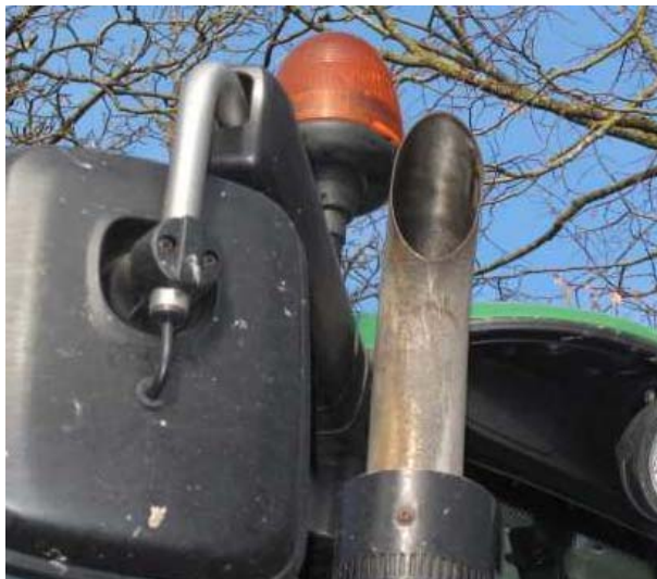
Abbildung 1: Russfreies Auspuffrohr nach 1600 Betriebsstunden mit Partikelfilter.
