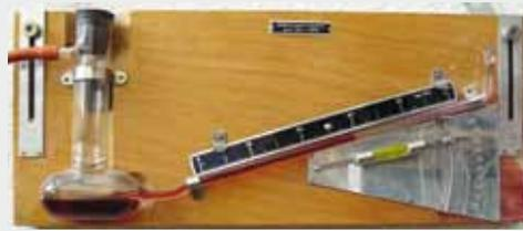
Figure 2 | Manomètre à tube incliné.
