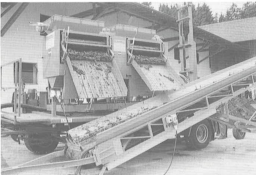
Abb. 2: Siebtrommelpresse (mobile Anlage).
