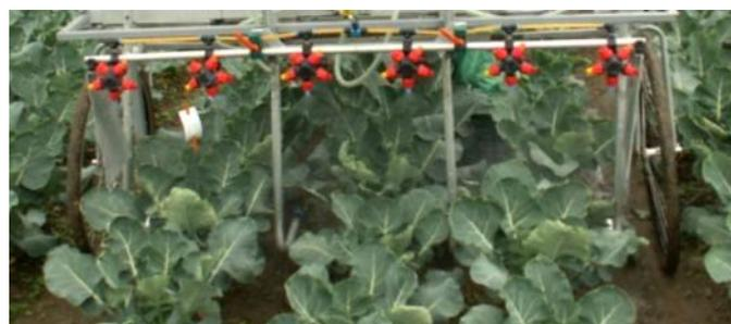
**Fig. 4:** Utilisation combinée de barres de traitement et de cannes suspendues (droplegs) avec un appareil pour petites surfaces sur une culture de brocolis.
