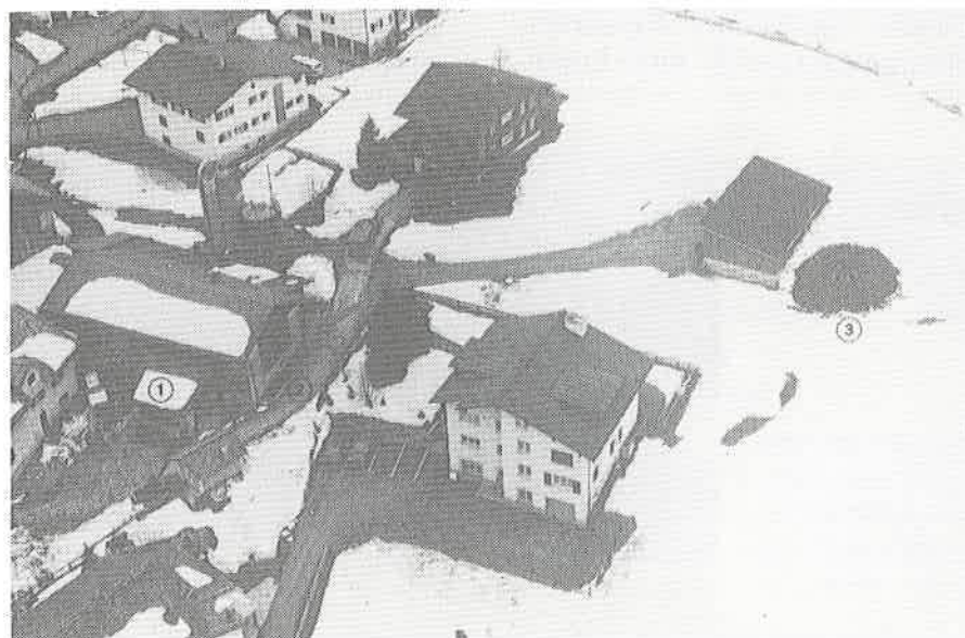
Abb. 5: Hier rechtfertigt sich der Einsatz einer Maulwurfanlage: 1 = Standort Presskolben 2 = Strasse 3 = Mistlager.
