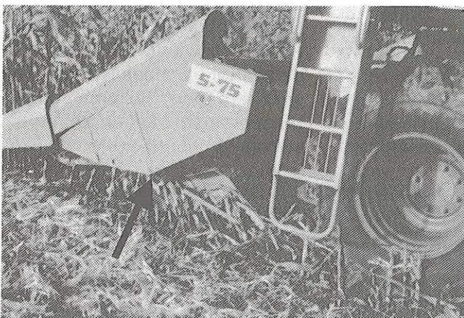
Abb. 10: Unvollständige Bearbeitung der ersten Maisreihe (Pfeil) durch den Unterbauhäcksler bei starker Hanglage.
