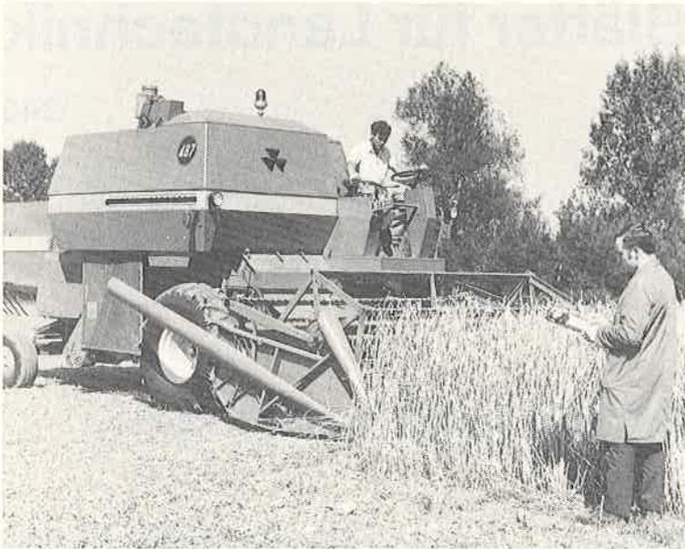
Abb. 1: Genaue Messungen der Arbeitszeit, der technischen Einflussgrößen und vor allem auch der Klimafaktoren beim Mähdrusch ergeben die Grundlagen zur Verbesserung des Maschineneinsatzes.
