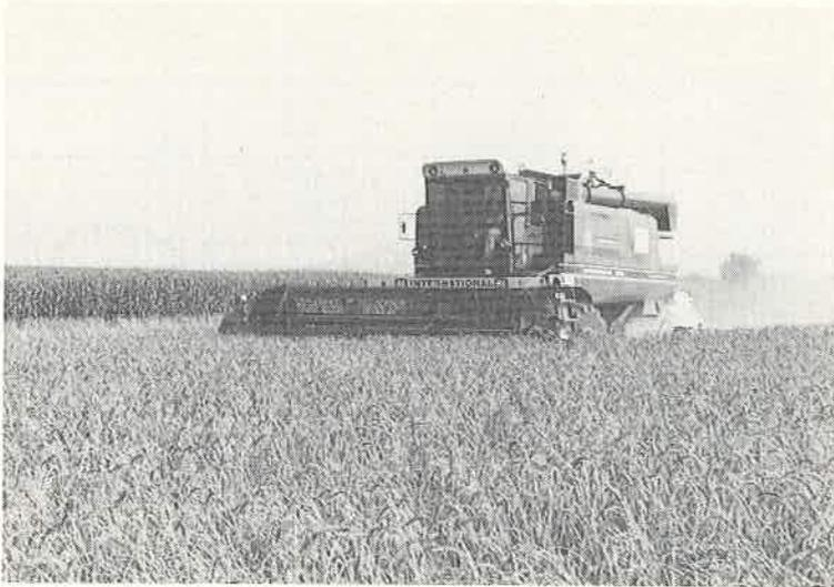
Abb. 4: Auch wenn sich hinter der Maschine bereits Staub zu entwickeln beginnt, können die Körner immer noch über 16% Feuchte aufweisen. Ohne Staub hinter der Maschine sollte aber nicht gefahren werden.
