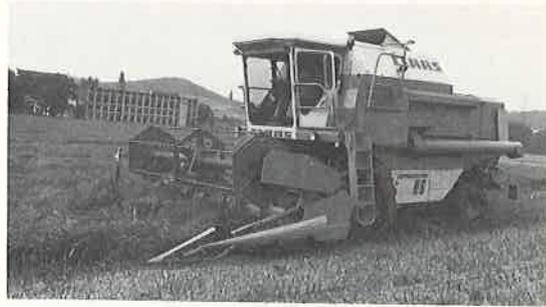
Abb. 9: Arbeit gegen die lagernden Rapsstengel. Bei dieser Arbeitsrichtung zeigten beide Schneidwerke die geringsten Körnerverluste.
