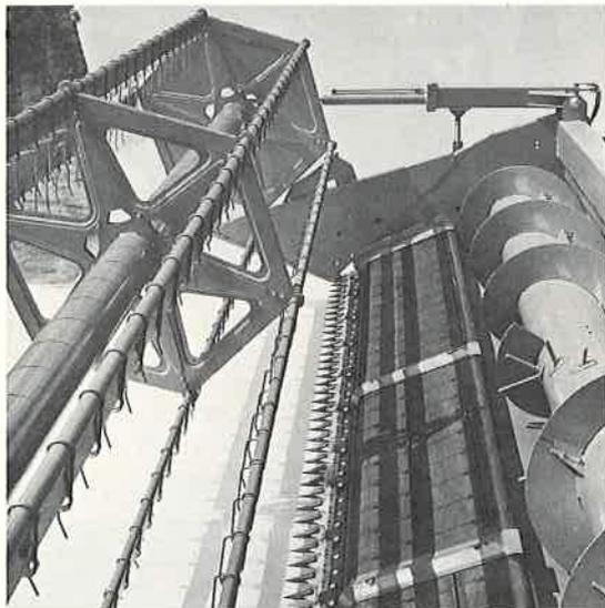
Abb. 3: «Universal»-Schneidwerk mit langem Schneidisch (MF). Der vergrösserte Abstand zwischen Messer und Einzugsschnecke wird mit einem umlaufenden Gummiband überbrückt. Dadurch kann sowohl Raps als auch kurz- und langhalmiges Getreide ohne Schneidwerkbau geerntet werden. Dieses bisher nur für eine Mähdreschermarke erhältliche Schneidwerk soll nach Herstellerangabe auch die Arbeitsweise der Dreschorgane günstig beeinflussen bzw. höhere Druschleistungen ermöglichen.
