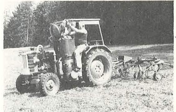
Abb. 1: Landwirtschaftstraktor Hürli Typ D 110, umgebaut auf Diesel-Holzgasbetrieb. 4,5 kg Holz ersetzen im Durchschnitt einen Liter Dieseltreibstoff.
