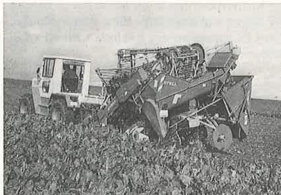
Abb. 3: STOLL V 35. Diese Maschine wird seit 1979 mit einer Vorrichtung zur selbsttätigen Regelung der Köpfstärke ausgerüstet. Im Gegensatz zu den Vorgängermodellen findet nun statt des Mitnehmerelevators ein Tragfördererelevator Verwendung.
