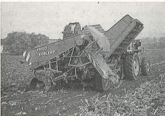
Abb. 1: Der FRIED-SCHMOTZER-Vollernter eignet sich vor allem für schwerere und steinige Böden. Durch das zweite Siebrad wird eine gründliche Rübenreinigung erzielt.
