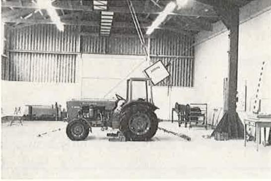
Abb. 4: Prüfstand für Fahrerschutzeinrichtungen in Tänikon.
