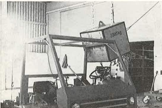
Abb. 5: Pendelschlagtest an einem Transporter (Motorkarren).
