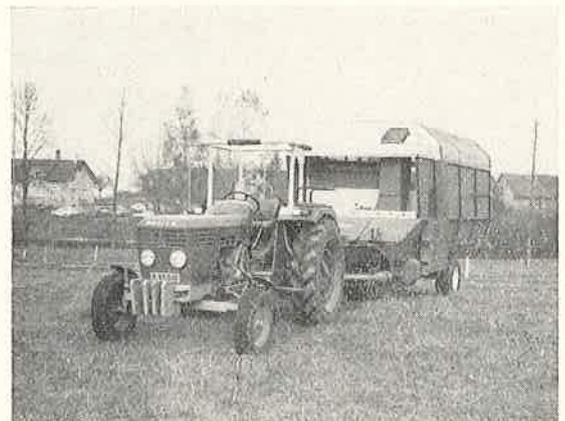
Abb. 1: Häckslerladewagen mit Pick-up. Oben ist der Rohranschluss für die Steigleitung ersichtlich (System Landsberg).
