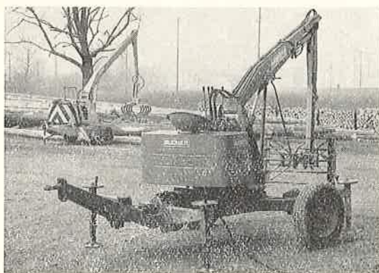
Abb. 4: Kran mit vier aufklappbaren Stützen.
