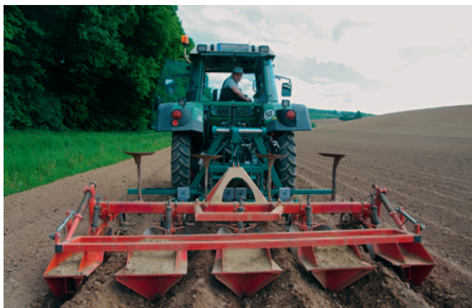
Abb. 6, oben: Nachlaufsteuerung Trimble TrueTracker. Mit zwei Antennen werden Traktor und Anbaugerät gleichzeitig auf Spur gehalten. Unten: Der hydraulische Verschieberahmen PSR Slide korrigiert Abweichungen des Anbaugeräts. Quelle: Geo-Konzept, Reichhardt
