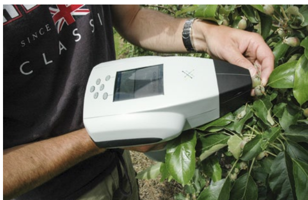
Figure 3 | Mesure des fruits au moyen du spectromètre proche infrarouge. (Photo: ACW)
