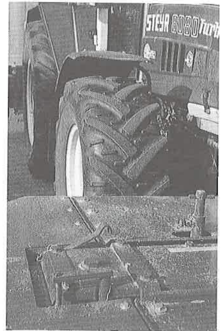
Fig. 8: une faucheuse frontale charge d'environ une tonne l'essieu avant et nécessite donc des pneumatiques adaptés.
