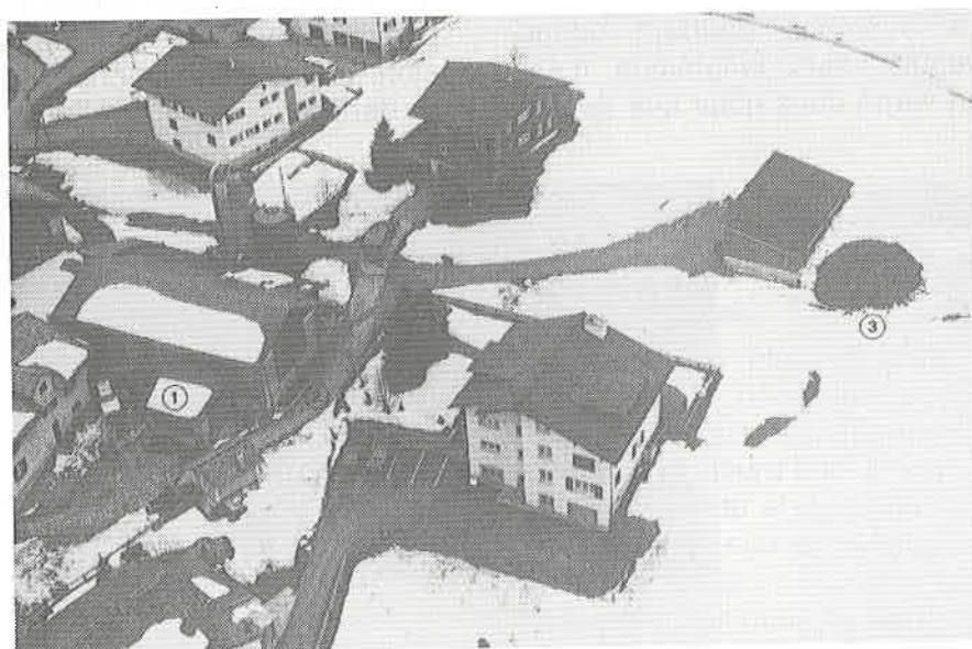
Fig. 5: Cette situation justifie l'utilisation d'un évacuateur, système «taupe»: 1 = emplacement du piston de pression; 2 = rue; 3 = fumière.
