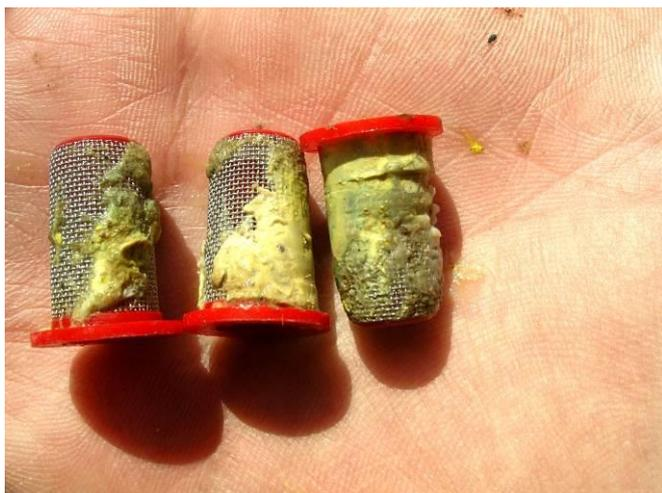
**Abb.2:** Bei ungeeigneten Tankmischungen kann es zu Ausfällungen und zur Schleimbildung kommen, was zur Verstopfung der Düsen führt (Foto J. Rüegg, Agroscope).
