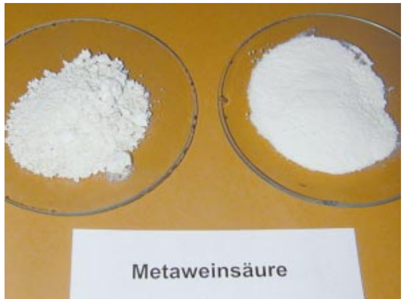
Abb. 3: Zustandsformen von Metaweinsäure. Die Korngrösse hat einen wesentlichen Einfluss auf die Stabilisierungsdauer.
