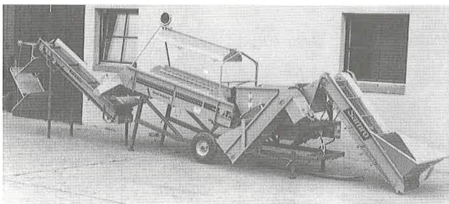
*Fig. 7: SAMRO KS 80. Les tubercules sur le crible supérieur peuvent être dirigés soit sur la voie de tri du milieu soit sur celle du côté droit. Dans ce dernier cas, la voie de gauche non approvisionnée est destinée au dépôt des tubercules de rebut. Cette variante ne convient pas à des performances rapides, car il se forme un bouchon à la sortie du crible supérieur.*
