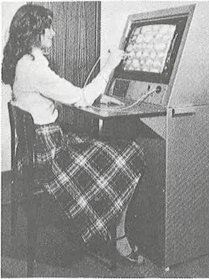
b) Les tubercules à trier, peuvent être séparés et marqués électroniquement sur un ou plusieurs écrans en couleur (téléselecteur).
