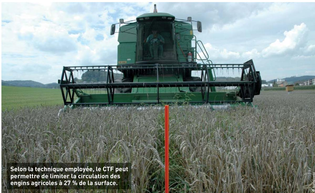
Selon la technique employée, le CTF peut permettre de limiter la circulation des engins agricoles à 27 % de la surface.
