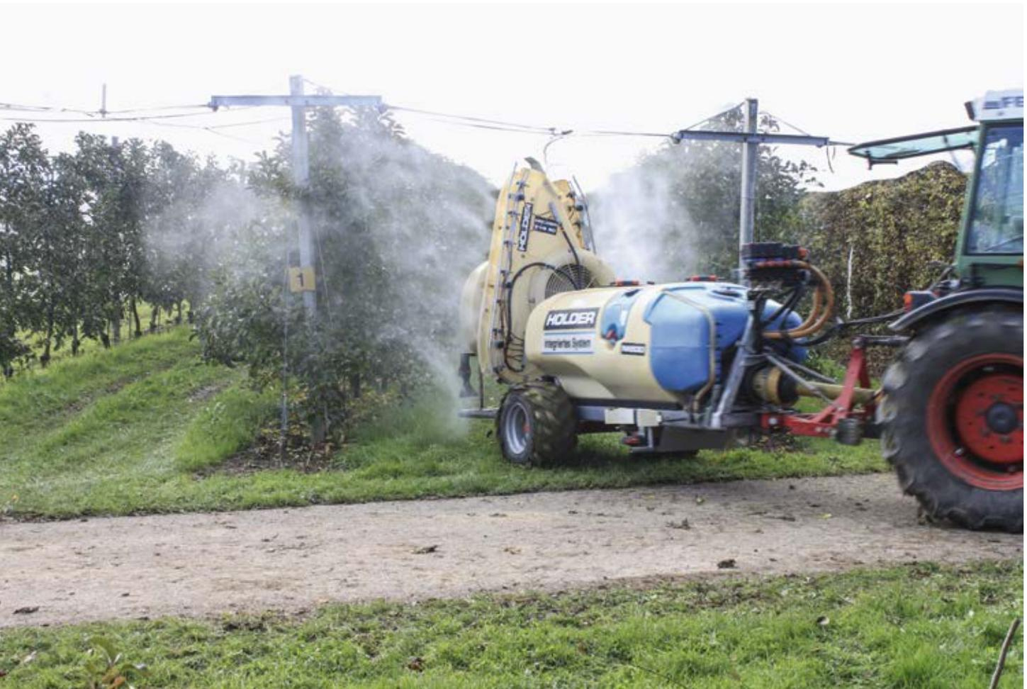
Abb. 1 | Bei jeder Sprühapplikation von Pflanzenschutzmitteln entsteht Abdrift.
