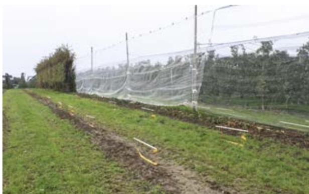
Abb. 3a | Depositionsmessung mit Filterstreifen. Im Vordergrund die abdriftreduzierende Massnahme «Netz am Feldrand», im Hintergrund die Windschutzhecke.
