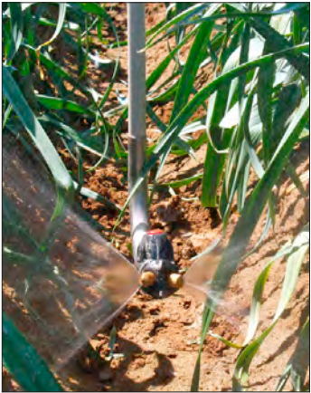
Die Spritztröpfchen dringen auch in den unteren Bereich des Pflanzenbestandes ein. Hier Droplegs in Lauch.
