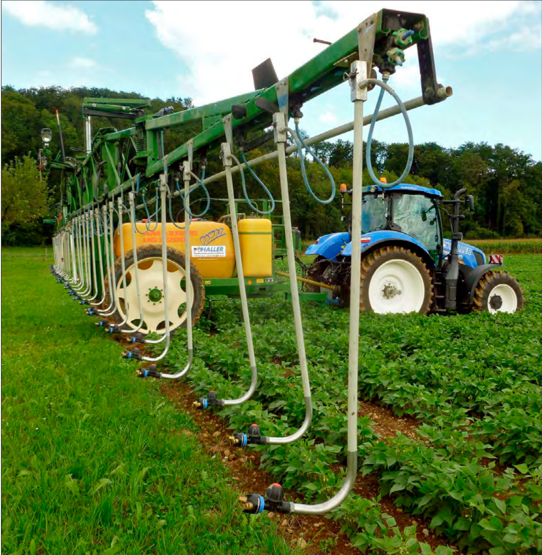
Das flexible und schwenkbar aufgehängte Kunststoffrohr ermöglicht starke Auslenkungen des Droplegs in alle Richtungen. Dank dem gebogenen Metallrohr am unteren Ende kann es ohne Beschädigung gelegentlich auch auf dem Boden aufschlagen oder eine Zeit lang nachgezogen werden. (Bild: Thomas Imhof)
