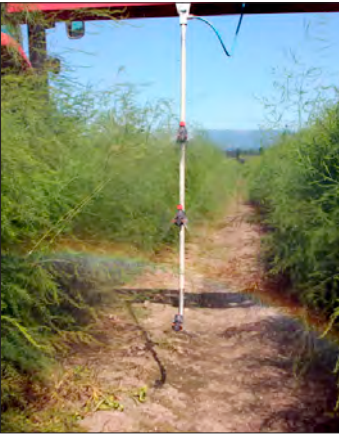
In Spargeln werden 120 cm lange Droplegs mit 6 Düsen (auf 3 Etagen) eingesetzt. (Bilder: Jacob Rüegg)
