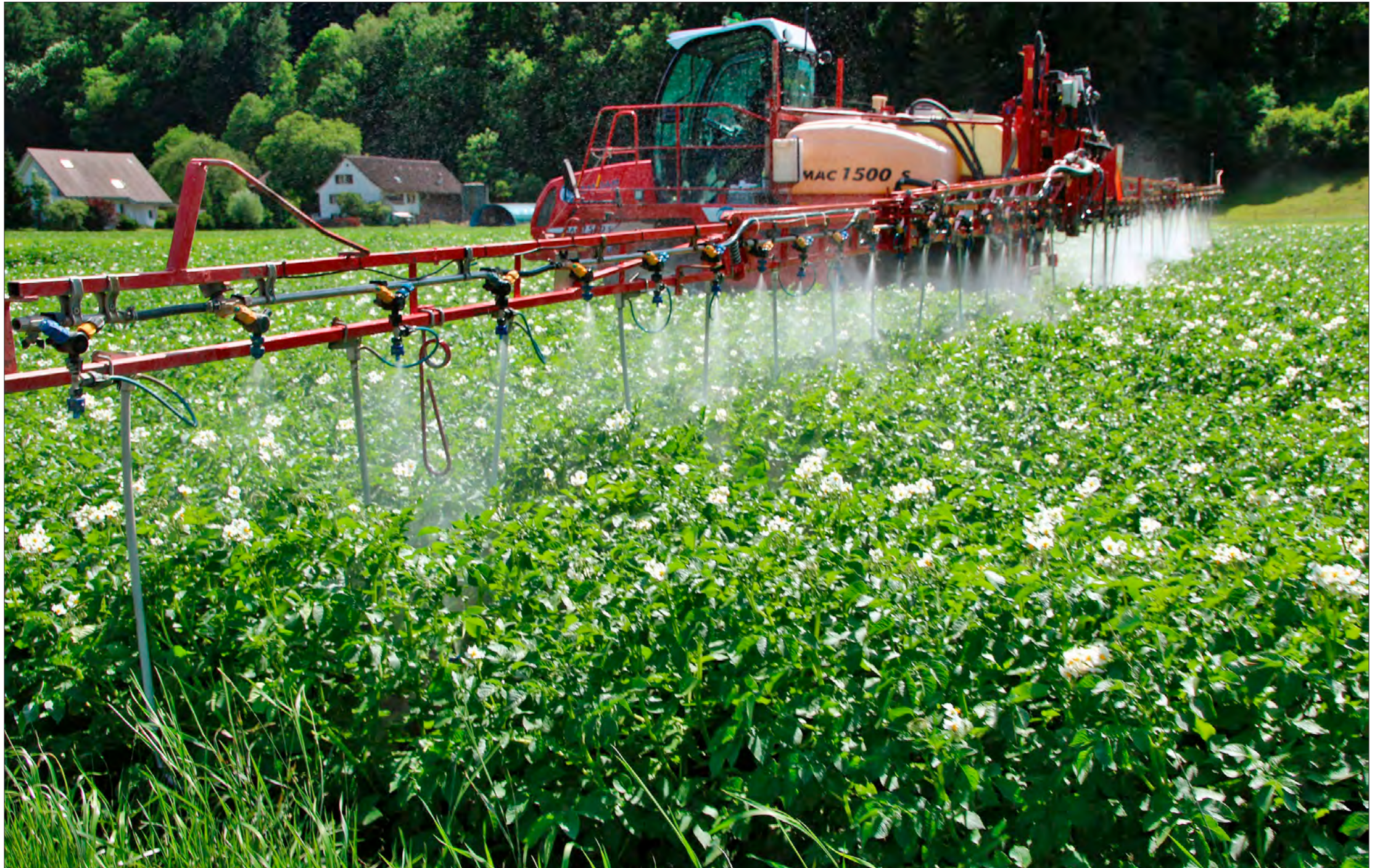
Bei horizontalen Spritzbalken können Droplegs einfach und kostengünstig nachgerüstet werden. Hier Droplegs im Einsatz in Kartoffeln. (Bild: Jacob Rüegg)
