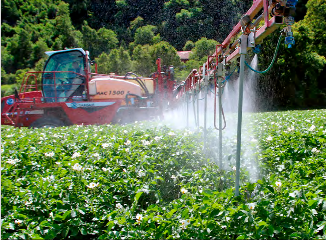
Die Droplegs suchen sich den Weg durch die Kartoffelstauden und können umgekippten Pflanzen ohne Mühe ausweichen oder über diese hinweggleiten. (Bilder: Jacob Rüegg)
