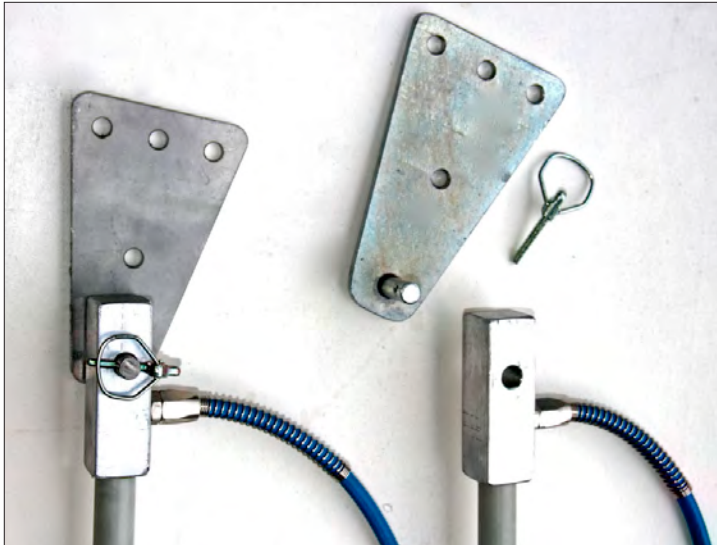
Mit der universellen Trägerplatte können Droplegs entsprechend dem Reihenabstand der Kultur bei den meisten Feldspritzbalken angebaut werden. (Bild: Jacob Rüegg)
