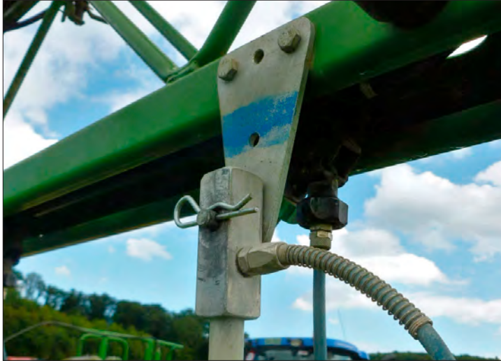
Die Trägerplatte wird entweder fix am Balken oder verschiebbar befestigt. (Bild: Thomas Imhof)
