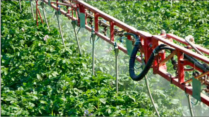
Rund zwei Drittel der Brühe werden in den unteren Bereich der Kartoffelstaude gesprüht, und ein Drittel wird über die Düsen des Feldbalkens von oben nach unten ausgebracht.
