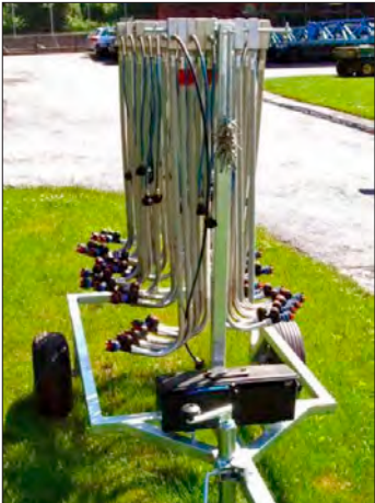
Beispiele selbst gebauter Aufhängevorrichtungen für die mobile Zwischenlagerung von Droplegs. (Bilder: Jacob Rüegg)
