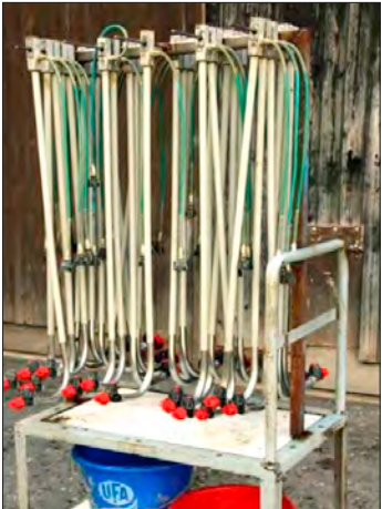
Beispiele selbst gebauter Aufhängevorrichtungen für die mobile Zwischenlagerung von Droplegs. (Bilder: Jacob Rüegg)
