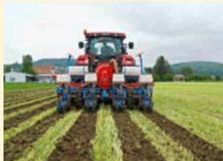
Die Streifenfrässaat ist eine schweizerische Entwicklung, die sichere Maiserträge und einen effizienten Bodenschutz bewirkt.
