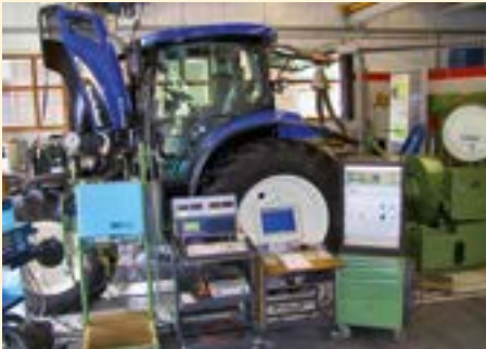
Harte Traktorentests: In Tänikon misst Agroscope den Energieverbrauch und die Emissionen landwirtschaftlicher Fahrzeuge.
