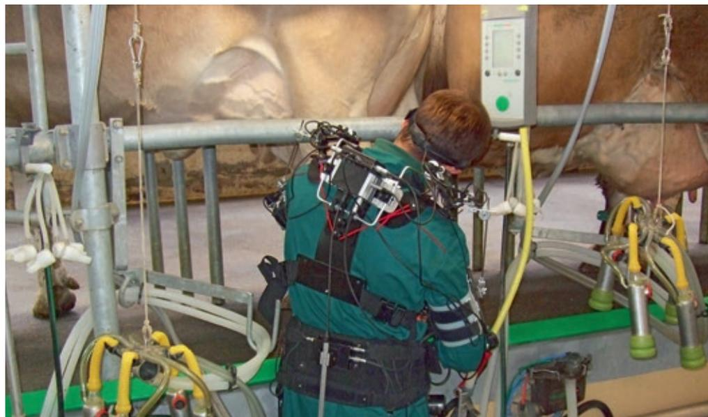
Analyse der Arbeitsbelastung im Melkstand mit dem CUELA-System (Fotos: Agroscope).
