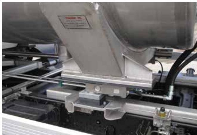
Figure 3: Pesons situés entre le faux châssis et la citerne (source: Kolly SA)
