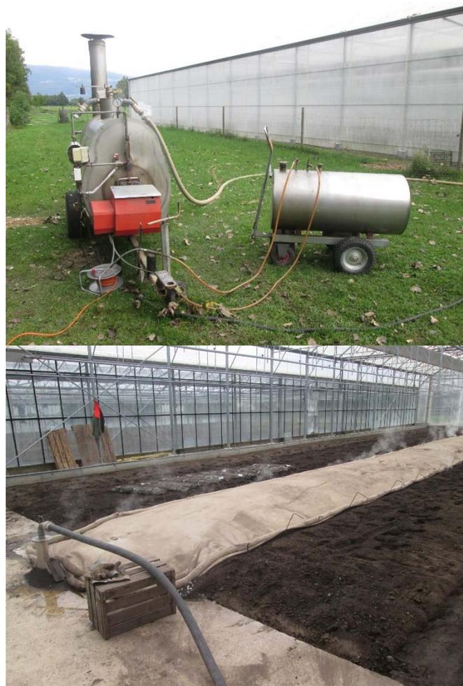
Fig. 1 : La vapeur générée par un brûleur mobile (en haut) est injectée dans le sol sous bâche (en bas).
