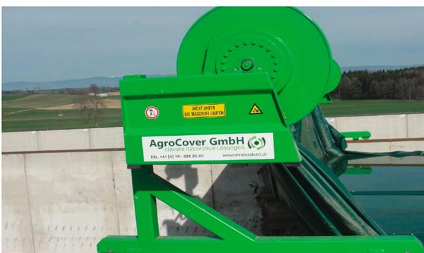
Abb. 3. Mit dem Frontlader oder einem Teleskopklader wird die Haspel auf dem Silo bewegt.
