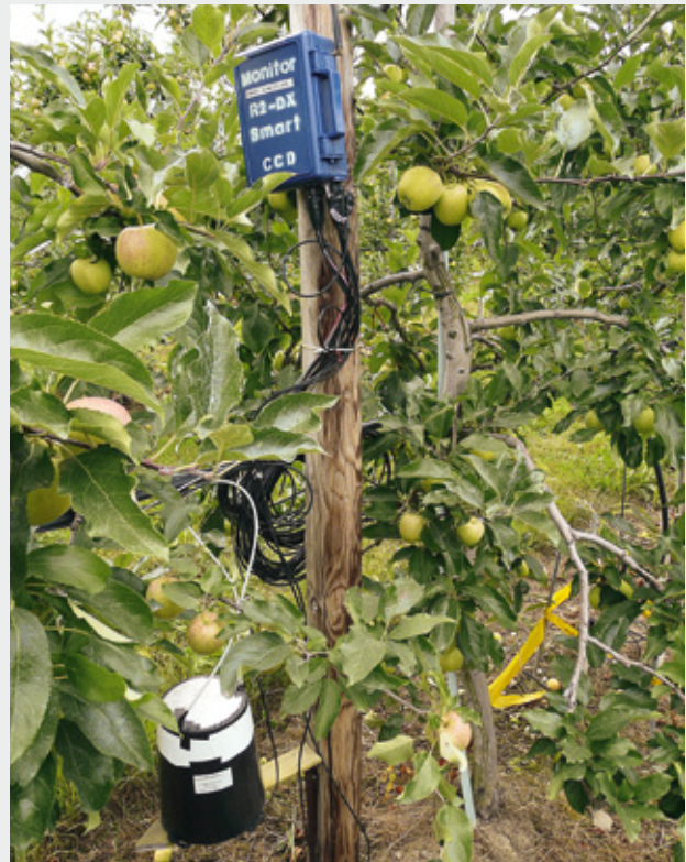
Figure 2 | La station de type R2-DX Smart est connectée à l'électrovanne qui commande l'irrigation. Le pluviomètre est isolé de la pluie et relié à un goutteur, ce qui permet d'enregistrer chaque irrigation. Les données climatiques proviennent de la station Agrométéo la plus proche.
