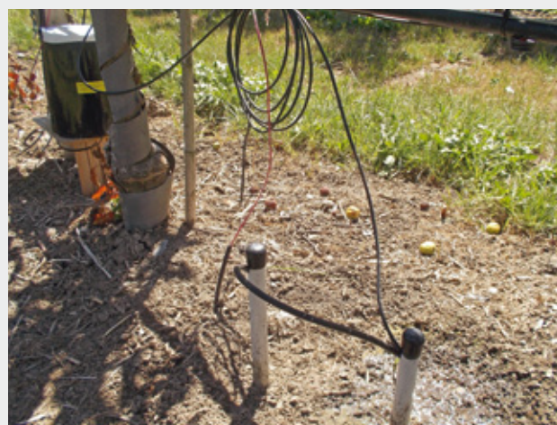
Figure 3 | Les sondes d'humidité de type Watermark® 2005S sont réparties en six groupes de deux dans une zone représentative du verger. Dans chaque groupe, la tension est mesurée à 25–30 cm et à 50–60 cm de profondeur.
