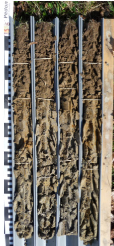
Abbildung 4: Entnahme volumetrischer Horizontproben mit der Humax-Bohrsonde (oben links; Methode f) bzw. der Humax-Schlagsonde (oben rechts; Methode g). Tiefenmessung am Bohrloch nach jeder Bohr-Etappe (unten links), Aneinanderreihung der entnommenen Bohrkern der einzelnen Etappen pro Bohrung (unten Mitte) und Bodenansprache mit Bestimmung und Vermessung der Horizontgrenzen (unten rechts).
