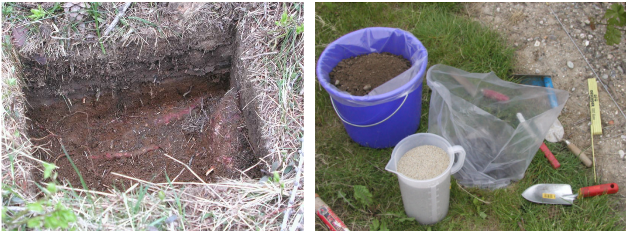
Abbildung 7: Entnahme einer grossen Volumenprobe mit Handschaufeln aus einer Grube (Methode g) mit anschließender Volumenbestimmung durch Auffüllen der Grube mit abgemessenem Sand (rechts).
