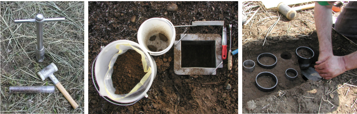
Abbildung 2: Entnahme von Volumenproben mit der Humax-Handsonde (links; RG-Proben, Methode a), mit dem Stechrahmen (Mitte; grosse Volumenproben, Methode c) und mit Stechzylindern (rechts; Methode h).
