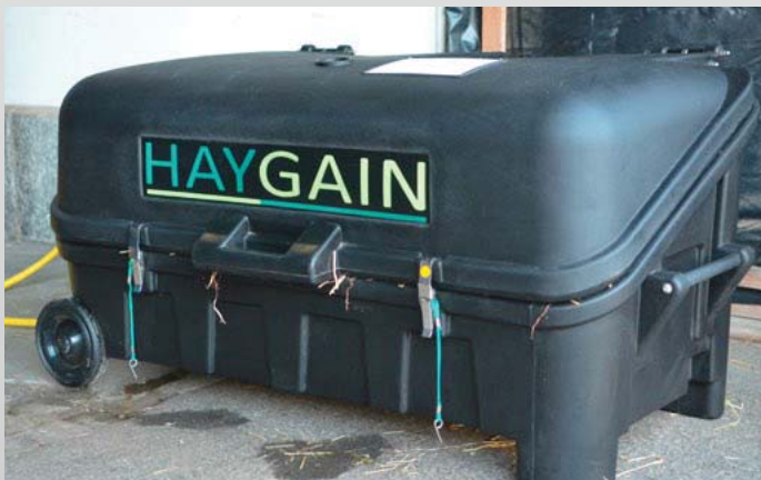
Fig. 1: Appareil de traitement à la vapeur utilisé pour cette étude Abb. 1: Gerät, welches zum Heudämpfen im Versuch eingesetzt wurde
