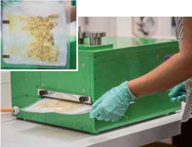
**Figure 2** | Presse à cylindres et sac de broyage pour le broyage de 25 pelures. Les 25 pelures contenues dans un sac de broyage sont broyées en quelques secondes par un passage unique dans la presse à cylindres.
