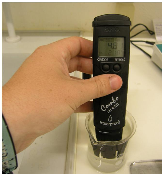
Figura 5. Misura del pH e della conducibilità elettrica (EC) di una soluzione nutritiva (fotografia: Agroscope).
