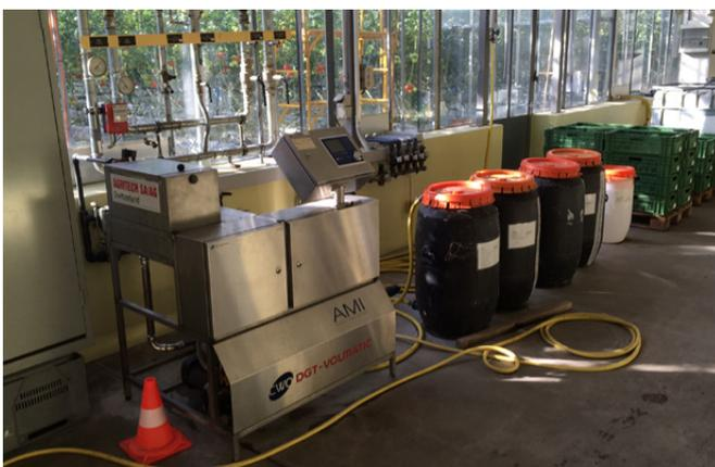
Figura 4. Installazione automatizzata per miscelare e gestire la fertirrigazione delle colture orticole in serra (fotografia: Agroscope).
