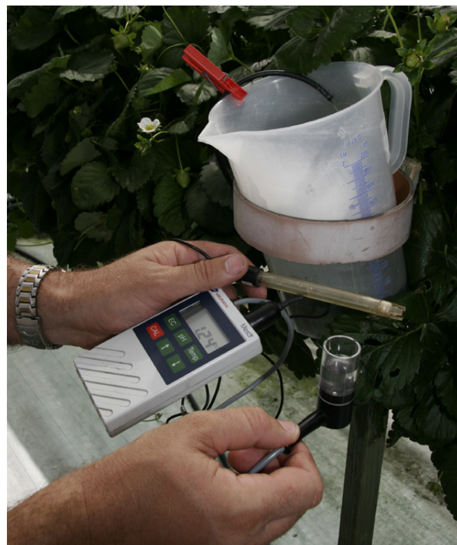
Figure 6. Contrôle des valeurs de pH et d'EC de la solution nutritive (photo: Agroscope).
