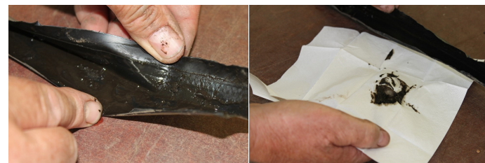
Fig. 4. Dépôts dans le T-Tape.
