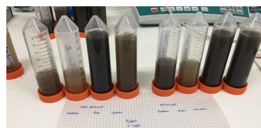
Fig. 5. Prélèvements de solution à différents niveaux du réseau T-Tape.
